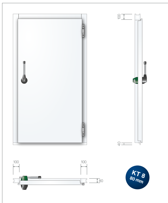
Koeldeur KT 8 80 mm isolatiedikte, +25 °C tot 0 °C Standaard blokkozijn voor inbouw in metselwerk
