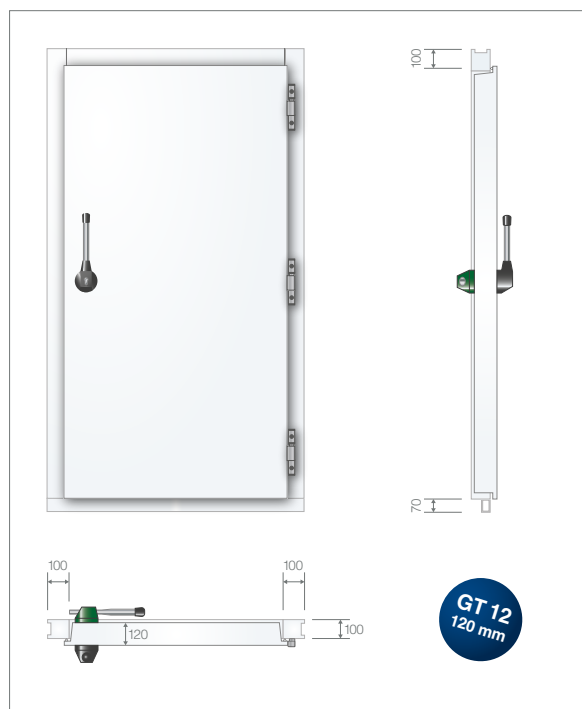
Vriesdeur GT 12 120 mm isolatiedikte, +25 °C tot -30 °C Standaard blokkozijn voor inbouw in metselwerk
