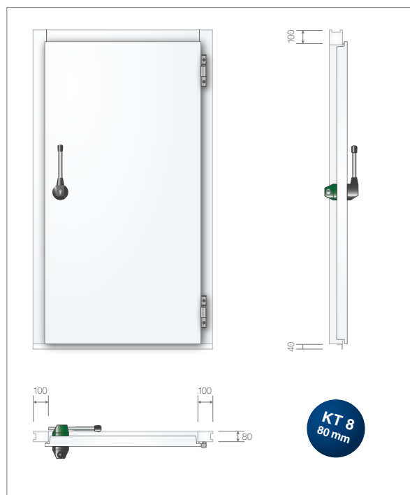
Drzwi do pomieszczeń chłodniczych KT 8 grubość izolacji 80 mm, od +25°C do 0°C standardowa rama blokowa do montażu w murze
